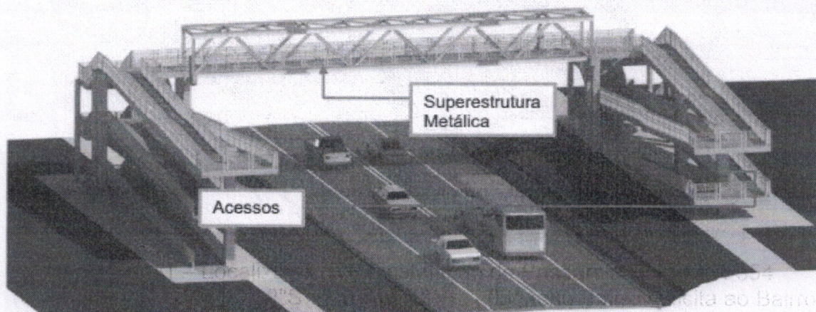
Imagem: 04 – Implementação de Passarela Tipo Vão Único
